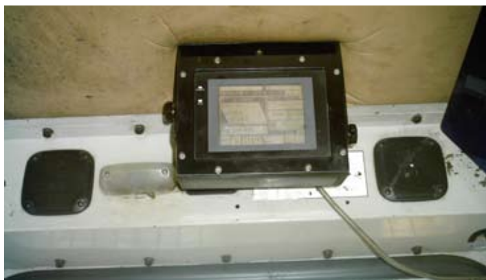
Pantalla táctil de MineSuite en la cabina de la pala (abajo)
