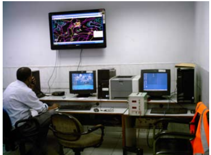
La función de mapeo de MineSuite permite que el supervisor del turno siga la localización del equipo en la mina en tiempo real
