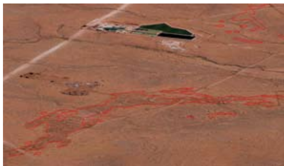
Vista isométrica de la operación de Beverley, mostrando los bordes del cuerpo mineral proyectados en la superficie, en rojo
