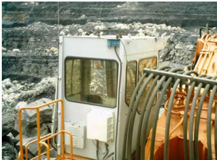
La Unidad de Proceso Remoto de MineSuite (RPU) montada fuera de la cabina de la pala en operaciones en la mina a tajo abierto
