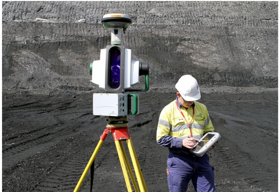
La operación es mucho más sencilla, con un solo controlador para el escáner y el GPS a través de una interfaz GPS integrada. La última Toughbook de Panasonic es la tablet más resistente del mundo, con un rango de temperatura más amplio y disco duro de estado sólido.
