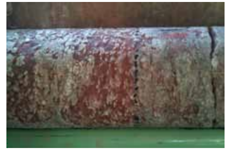
En la muestra de sondaje se pueden distinguir claramente estratos, cristales de sales de KCl, áreas de impureza y capas guía de arcilla.
