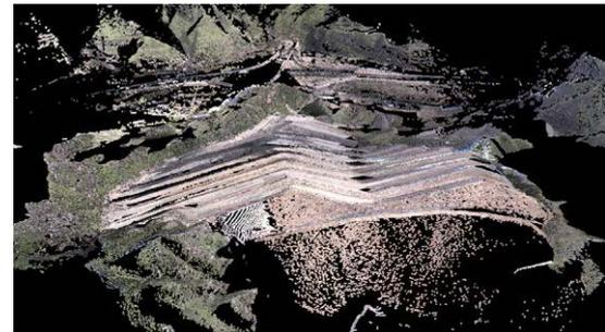
*El análisis de estabilidad se puede conducir mediante detalladas nubes de puntos I-Site junto con imágenes digitales*
