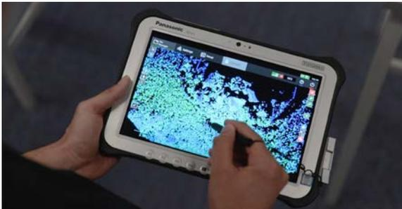
La nueva técnica de sombreado simula mejor la iluminación del mundo real, lo que facilita mucho la interpretación de datos 3D, como nubes de puntos capturadas por los escáneres láser Maptek™.
