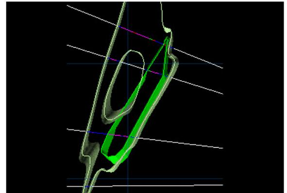
Sección transversal que muestra la zona mineralizada de DomainMCF y las estructuras de alambre construidas por los geólogos de Sibanye-Stillwater
