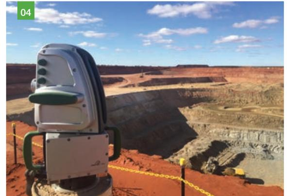
'Nuestro tranque de relaves tiene 1,6 km de diámetro. Podemos conducir alrededor del perímetro con el escáner montado en el techo, procesar en PointStudio y tener una superficie final en menos de medio día. Disruto usando el software: la edición, creación y fusión rápidas de superficies es simplemente fantástica.'
