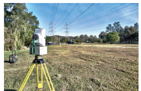
Escaneo automático localizó 24 conductores separados (incluidos los cables de tierra arriba)
