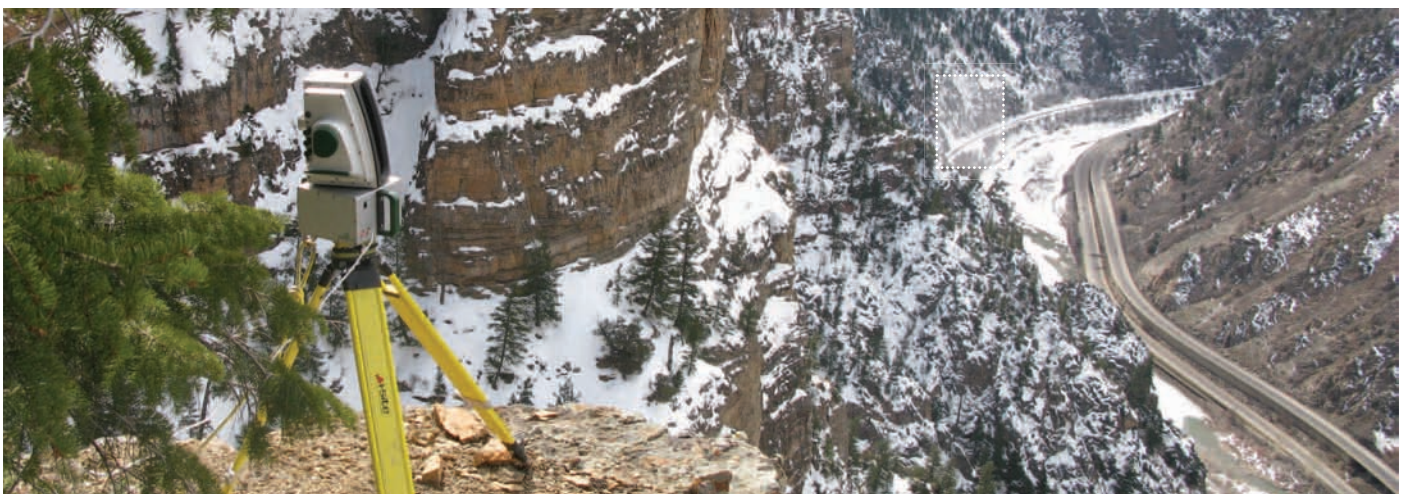
El escáner láser I-Site 8800 con vistas de desprendimiento de rocas
