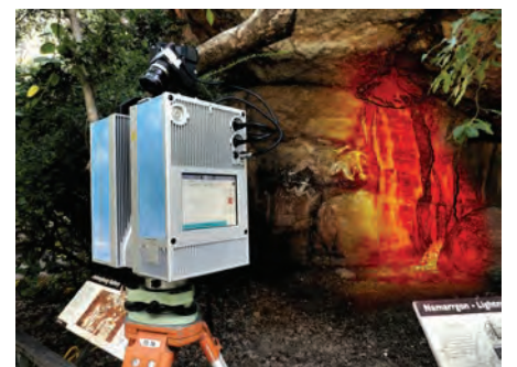
El escáner Z+F en la Galería Abangbang en Nourlangie. La zona color naranja representa una muestra de puntos en 3D tomados del escáner.
