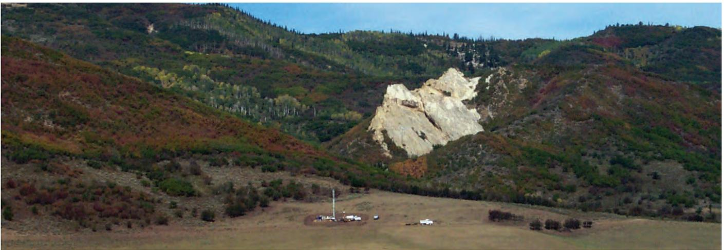
*A pesar de las camas inclinadas en la parte posterior, el sondaje mostró capas planas de las muestras de los núcleos*
