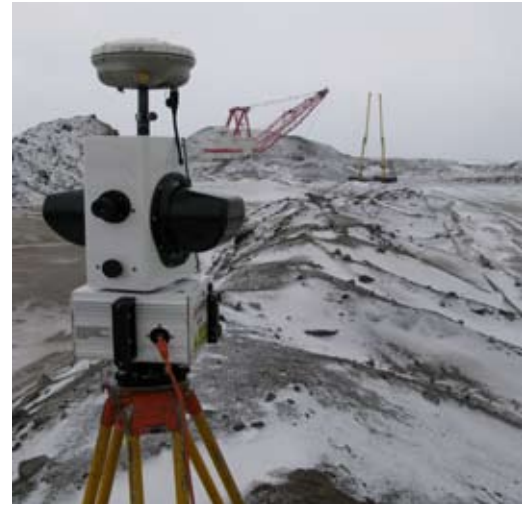
I-Site maneja los desafíos de levantar múltiples acopios alrededor de recuperador y caminos de acceso a vehículos
