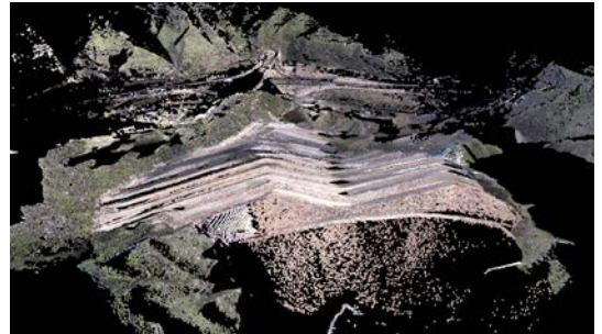
Se puede realizar el análisis de estabilidad mediante nubes de puntos detallados I-Site junto con imágenes digitales.
